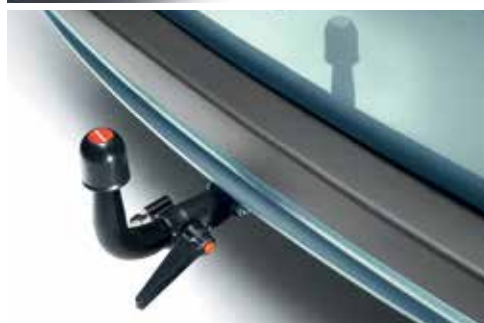
HAK Z KULĄ DEMONTOWANĄ BEZ UŻYCIA NARZĘDZI
